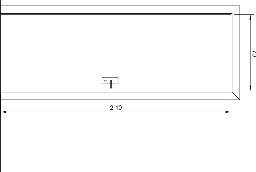
PM2 VISTA INTERNA PORTA DE MADEIRA - ACAB. FAIDIGA - SINCOL OU PORMADE FECHADURA PAPAIZ - ML340 CR R-182.357 FECHADURA PAPAIZ - ML340 CR R-170.557 (NOS BANHEIROS DOBRADIÇA PAPAIZ - SÉRIE 1296.3/12X2.1/2" 1CRA
